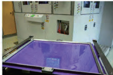
图4. Fraunhofer其FOPLP面板尺寸为610 mm×457 mm，是300 mm晶圆面积的3.8倍。
