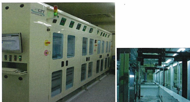
圖一：弘塑科技所設計製造之8吋自動化Wet Bench濕式蝕刻設備。
